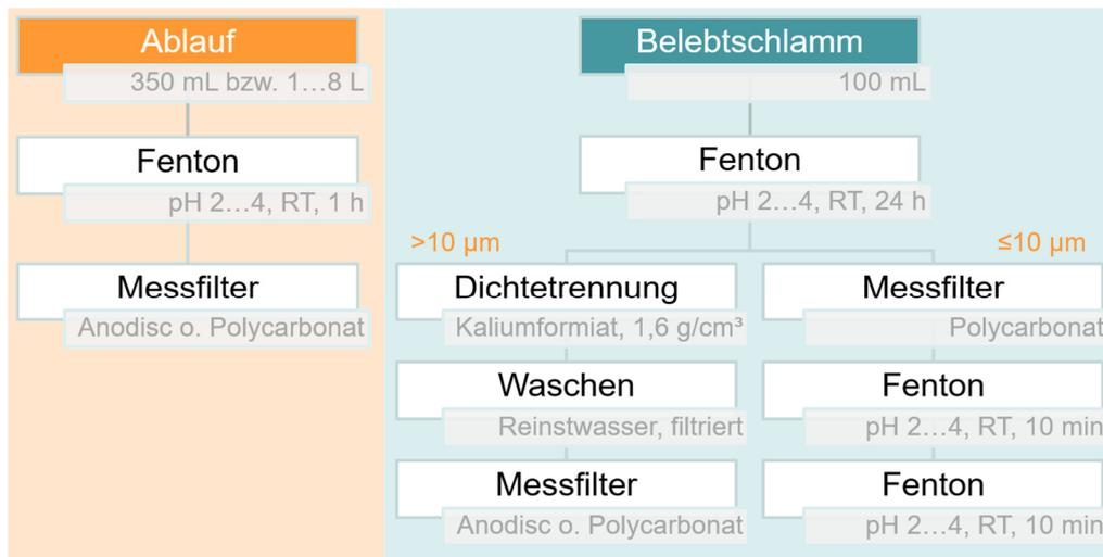
Abbildung 45: Optimierte Probenaufbereitung für Ablauf und Belebtschlamm
