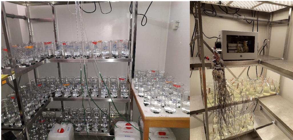
Abbildung 69: Beispielhafter Versuchsaufbau für Bioassays mit *Gammarus roeseli* (links) und *Dreissena polymorpha* an Sensoren (rechts) in der Klimakammer. Bild: A. Götz, TUM.
