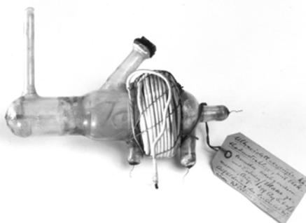
Abb. 8: Röhre Lenards zur Erzeugung langsamer Kathodenstrahlen mittels UV-Licht aus dem Jahre 1899 (Inv. Nr. 73616). Foto: DMA, BA 5491.
