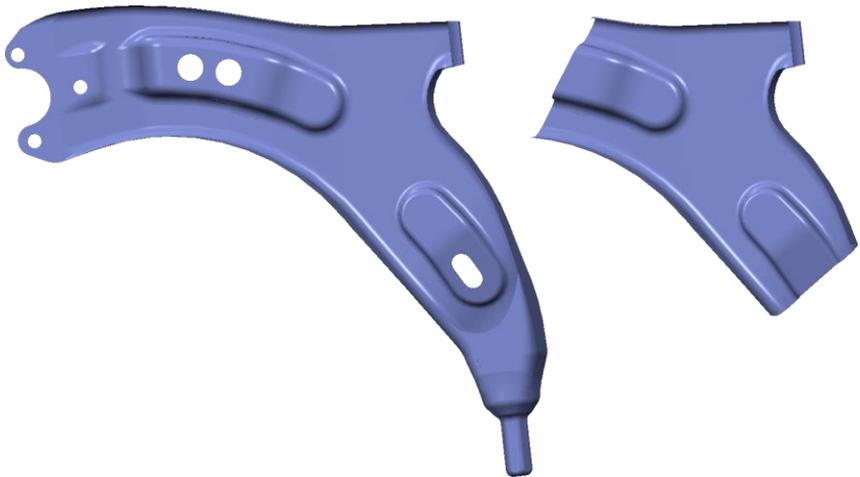
*Abbildung 5-20: Modellvorbereitung zur Anwendung des Patch-Optimizers auf die Tiefziehgeometrie*
