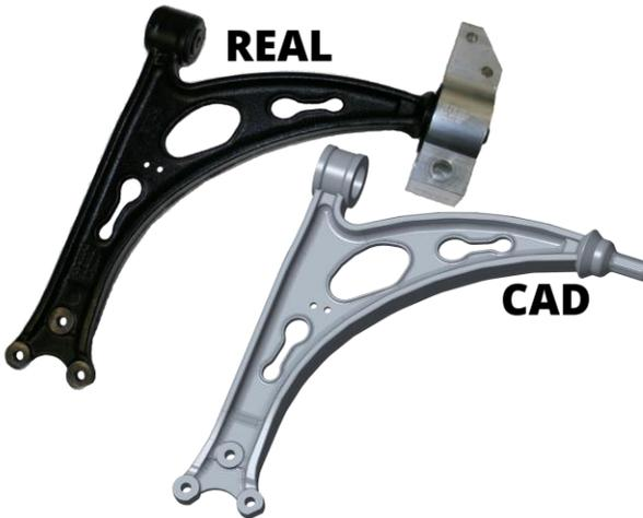
*Abbildung 5-5: Ausgangsbauteil Stahlguss (reales Bauteil und CAD-Modell)*
