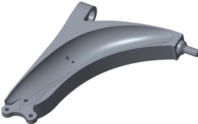
*Abbildung 5-9: Angepasster Bauraum nach Fertigbarkeitsanalyse*
