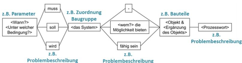
Abbildung 3-13: Elemente einer Anforderungsschablone nach Rupp et al. [10]
