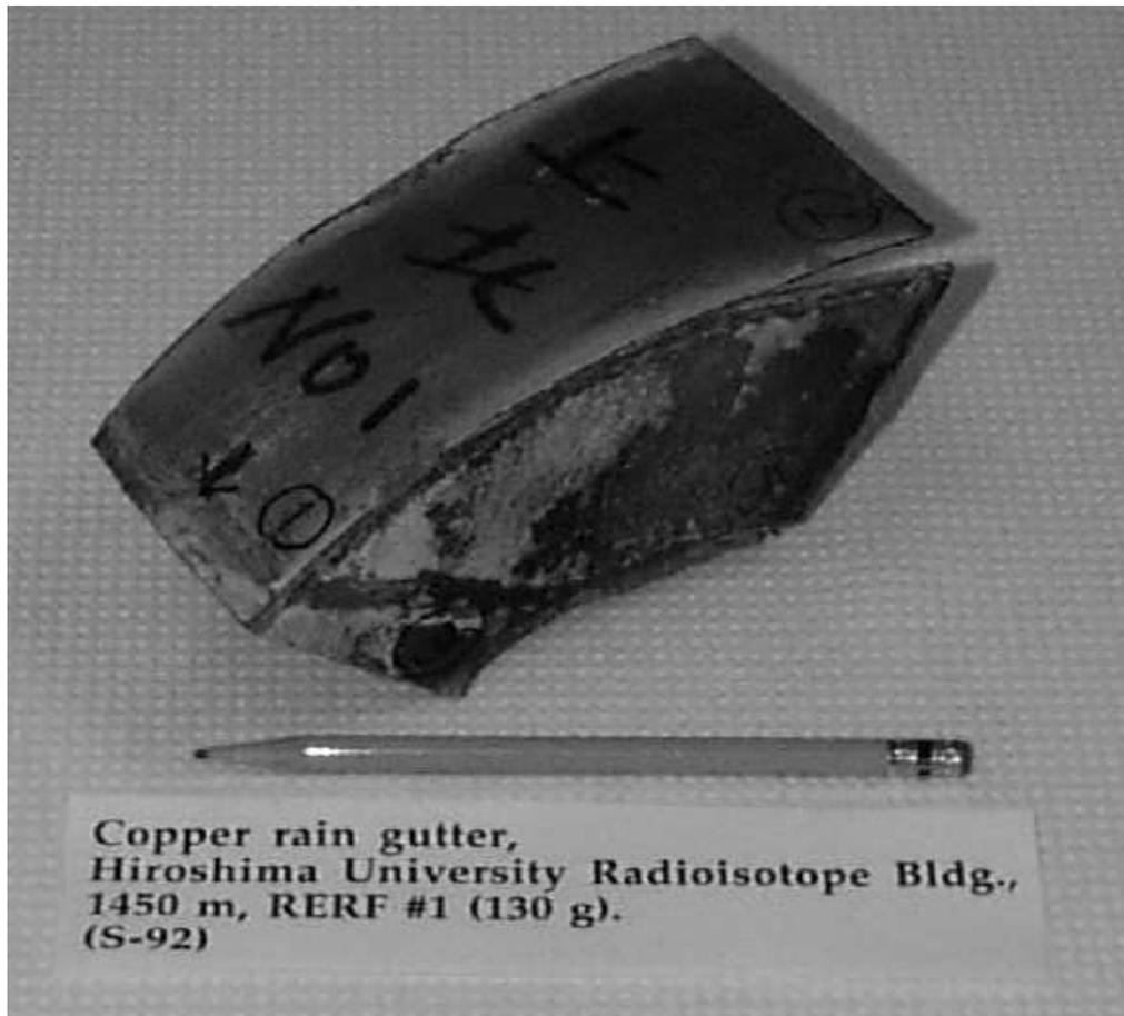
Abbildung 5.4: Regenwasserspeier des Radioisotopengebäudes der Universität Hiroshima [146], der Abstand der Probe betrug 1461 m ( $r_{gr}$ ).
