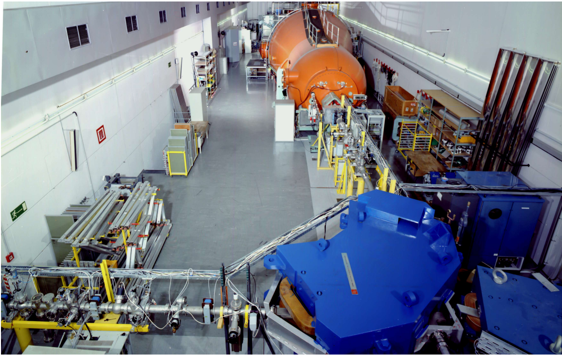
Abb. 11: Die Tandemhalle am MLL in Garching. Im Vordergrund der Analyse magnet (blau), dahinter die Strahlführung mit dem Wienfilter der Hochenergieseite und im Hintergrund der Tandembeschleuniger (orange).
