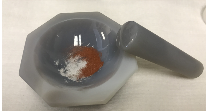
Abbildung 3.6: Vermengung des gemahlene Siedesalzes mit Kupfer
