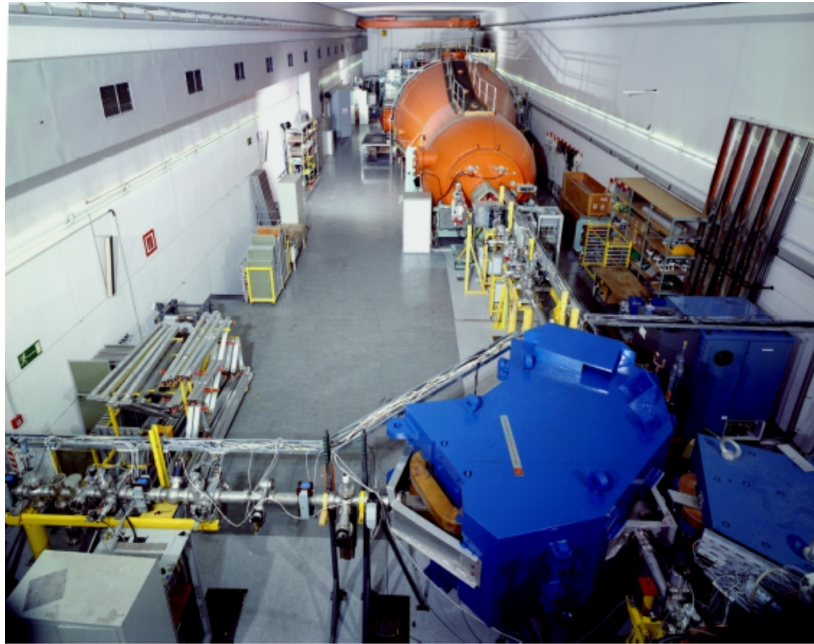
Abbildung 3.3: MLL - Beschleunigerhalle; Tandem (orange) und 90^\circ - Magnet (blau)
