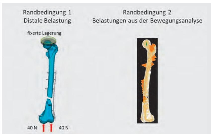
Bild 9: Die zwei verschiedenen Randbedingung für die FE-Simulation.
