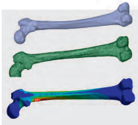
Bild 1: Die hier dargestellte Überführung von STL-Daten in ein CAD-Modell wurde in weniger als einer Minute erledigt.
