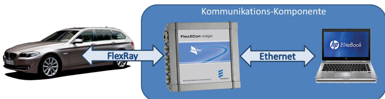
Abbildung 11 Konzeptzeichnung, Verfeinerung der Kommunikations-Komponente, Fahrzeug (links), Midget (mittig) und Notebook (rechts)
