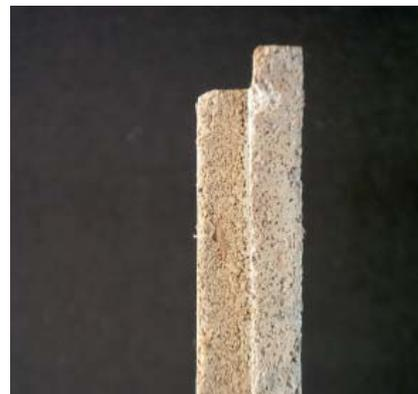
Abb.: 5.12 Kanten der Sandwichplatte
