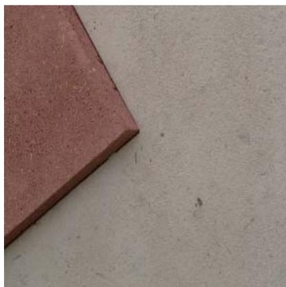
Abb.: 6.38 Farbiger Holzleichtbeton
