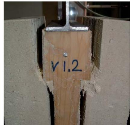
Abb.: 4.18 Abscheren der HLB-Nocken
