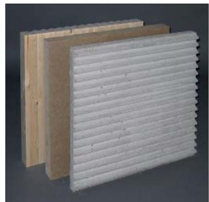
Abb.: 4.8 in HLB-MH-Verbundbauweise
