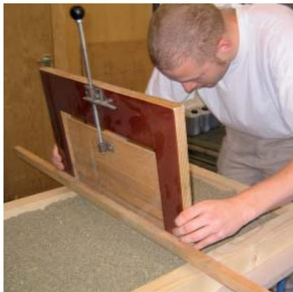
Abb.: 6.13 Abziehen der Mischung
