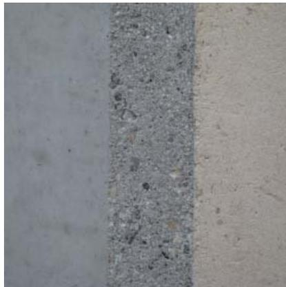
Abb.: 6.37 Übergang Holzleicht/ Beton
