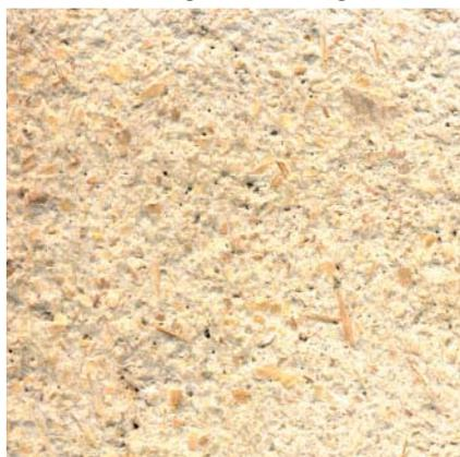
Abb.: 6.26 Gebürstet mit Stahlb.( M1:1)
