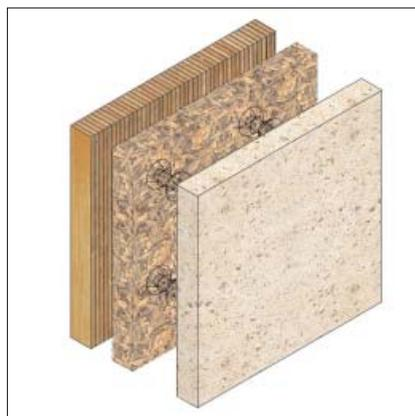
Abb.: 4.7 Mehrschichtige Aufbauten
