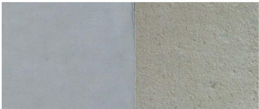
Abb.: 5.18 Materialkombination Sichtbeton / Holzleichtbeton
