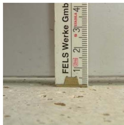
Abb.: 6.2 Messung Plattenkrümmung
