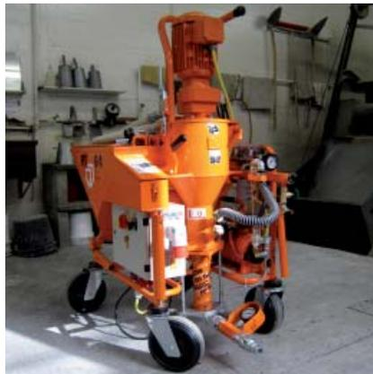
Abb.: 6.20 Pumpmaschine Fa. Knauf PFT
