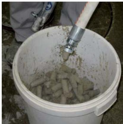
Abb.: 6.22 Gepumpter HLB-Frischbeton
