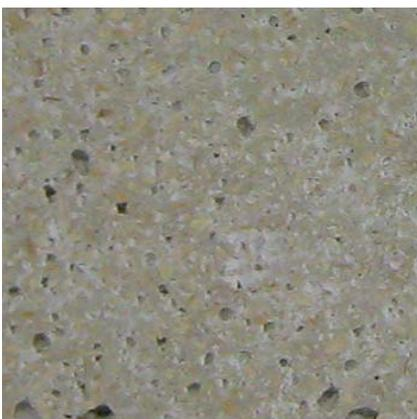
Abb.: 6.31 Luftdruck gereinigt (M 1:1)
