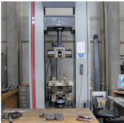
Abb.: 4.34 Aufbau der Auszugsversuche
