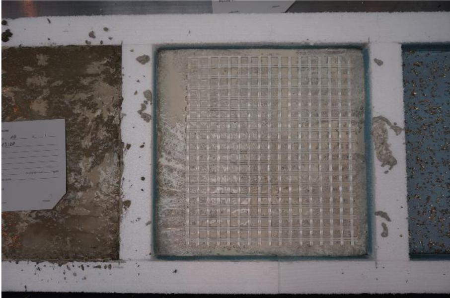
Bild 19: M. Pätzold, Schaltisch, Auftragener Weisszement mit Einmischung und Glasfaserbewehrungsmatte, 2015
