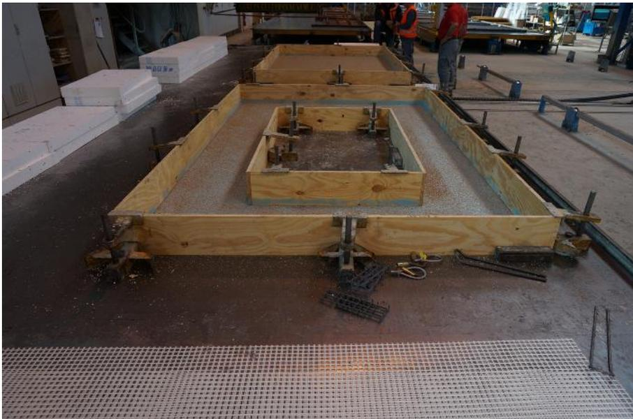
Bild 25: M. Pätzold, Schaltisch mit Abbindeverzögerer und Eintreuung, 2015
