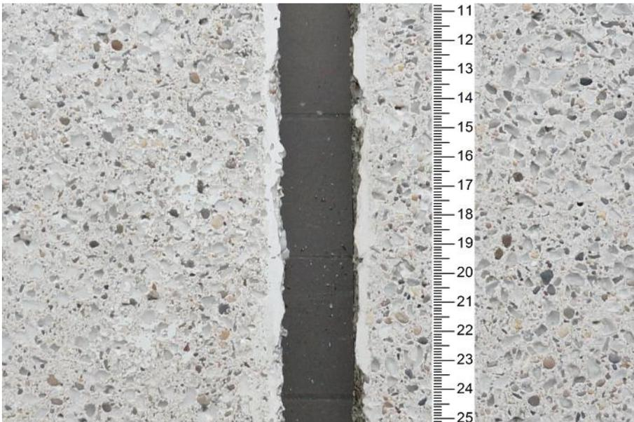
Bild 23: M. Pätzold, alkaliresistente Glassplitter in Probekörper rechts bewittert, bei nicht alkaliresistenten Glassplittern besteht die Gefahr, dass die Einstreuungen ausgewaschen werden, links unbewittert, etc., 2016
