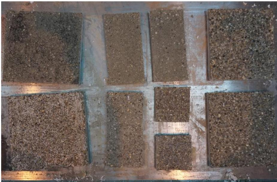
Bild 16: M. Pätzold, ausgeschaltete und gewaschene Probekörper div. Eindringtiefen, Ergebnisse sind negatives Absanden diverser Einstreuungen und wenig Konstrastbildung zum dunklen Betonuntergrund, 2015
