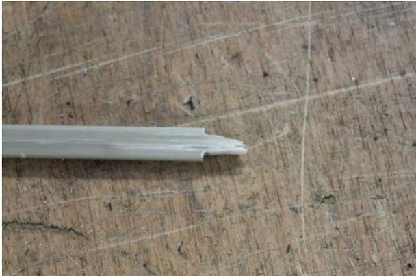
Bild 7: Th. Lechner, Zugversuch Glasfaserstabanker System Thermomass®, 2015
