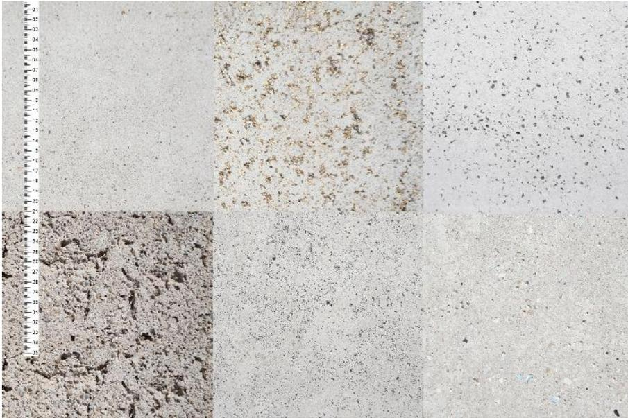
Bild 21: M. Pätzold, fertig gestellter, ausgeschalter und ausgewaschene Probekörper mit unterschiedlichen Einstreuung, von oben links bis unten rechts Naturstein Blau S, Messinggranulat, Schaumglas, Substrat, Eisengranulat, PET-Recyclat A-PET-Tiefziehqualität, 2015
