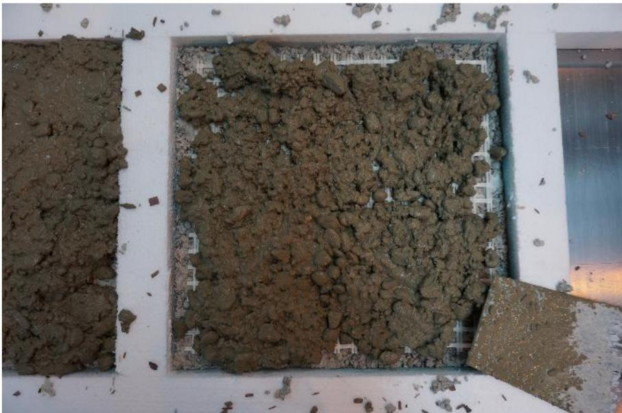
Bild 20: M. Pätzold, Schaltisch, Auftragener Normaöbeton C50/60 auf Glasfaserbewehrungsmatte, 2015
