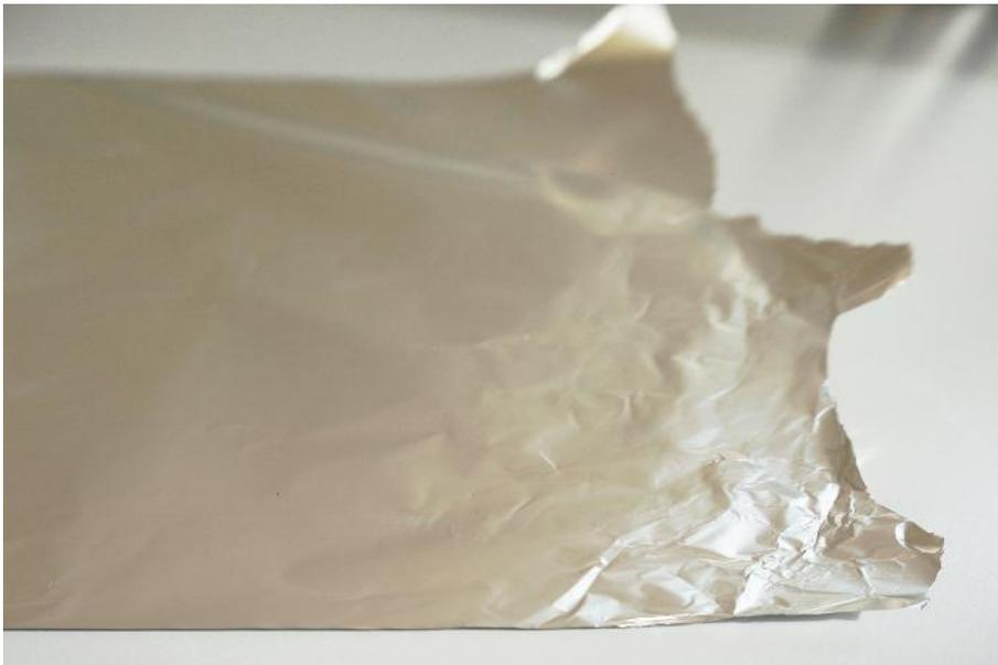
Bild 10: M. Pätzold, infrarot reflektierende Folie, Aluminium,  $d=0,010$  bis  $0,015\text{mm}$ , 2016
