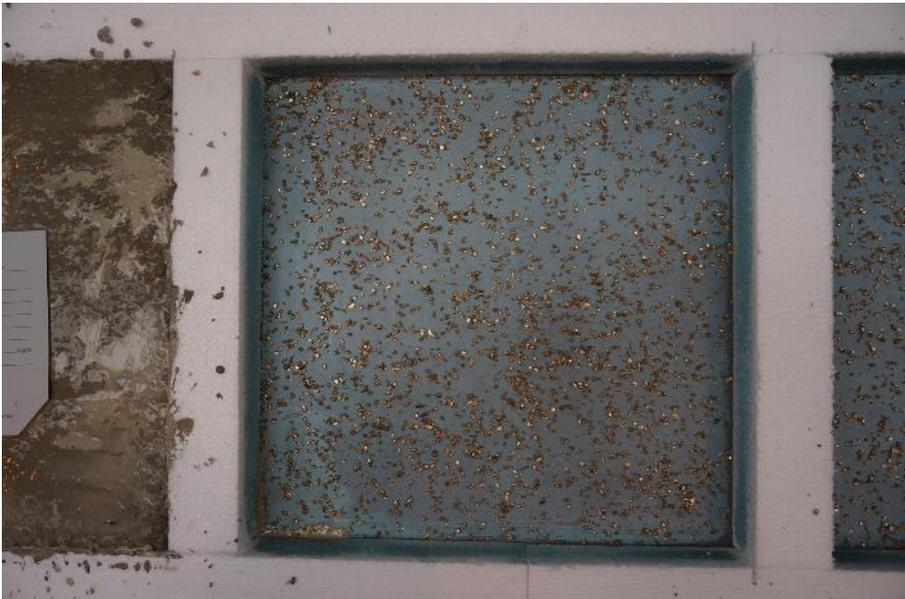
Bild 18: M. Pätzold, Schaltisch, Abbindverzögerer mit 0,25mm Einbringtiefe und Einstreuung Messinggranulat, 2015
