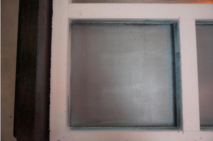
Bild 17: M. Pätzold, Schaltisch, blanker Edelstahl mit Polystyrolschalung, 2015
