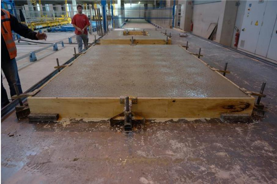
Bild 31: M. Pätzold, Rütteln der Gesamtkonstruktion, 2015
