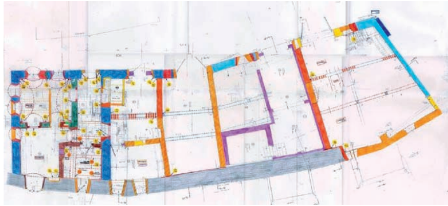
Abb. 2: Baualtersplan Erdgeschoss nach Restaurator Mühlbauer.
