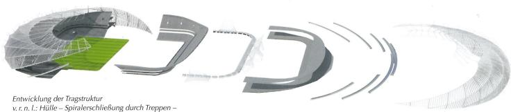
v. r. n. 1.: Hulle – Spiralerschließung durch Treppen – Haupterschließung oberer und unterer Umgang – Logenboxen und Funktionskerne – Ober- und Unterrang
