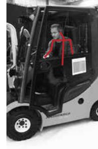
2. Mit dem linken Fuß voran nach links aus der Kabine drehen
