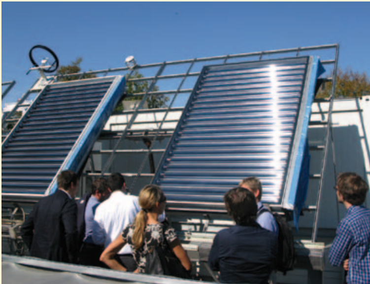
Abb. 3 Messungen: Mit einer Testvorrichtung wurde die solare Leistungsfähigkeit gemessen und anschließend Expositionstests durchgeführt. Am Institut für Thermodynamik und Wärmetechnik (ITW) in Stuttgart sind die fertigen Fassadenmodule als O-Serie montiert – mit und ohne Deckscheibe. Quelle: Universität Stuttgart, IBK 2
